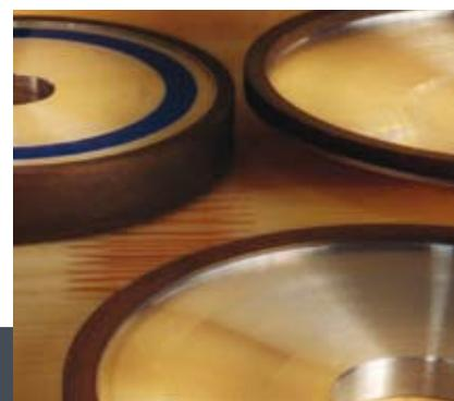
**Głębokość skrawania.** Zaleca się stosować głębokość skrawania nie przekraczającą 1/3 wielkości ziarna supertwardego. Dla przykładu, dla ziarna D151 zaleca się głębokość skrawania do 0,05 mm. Przekroczenie tej wartości powoduje dużo szybsze zużycie ziarna prowadzące często do zniszczenia.
