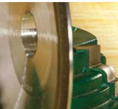
**Глубина резания.** Рекомендуется применение глубины резания не превышающее 1/3 величины супертвердого зерна например, зерно 151 – глубина резания до 0,05 мм.
