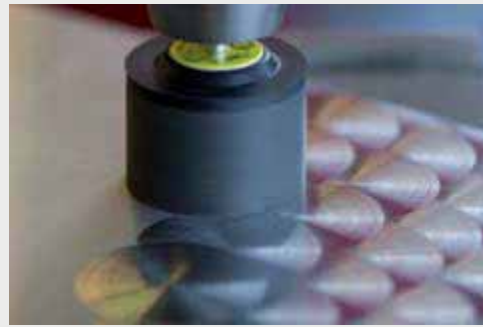
Przykład szlifowania ozdobnego za pomocą ściernicy do marmurkowania R-Flex SFM 656 na blasze ze stali szlachetnej.
